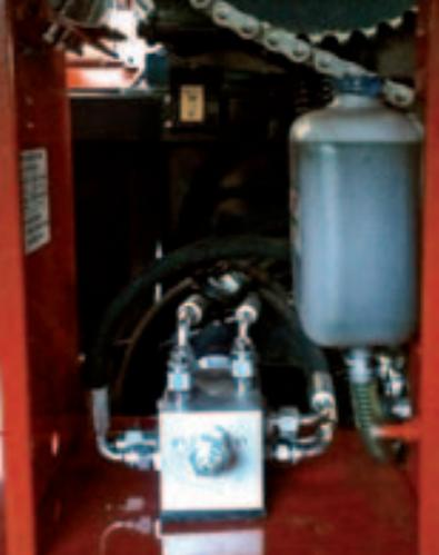
Soupape hydraulique pour le maintien de la pression dans le circuit hydraulique.
