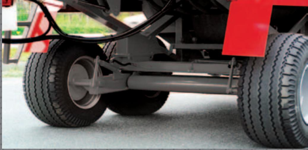
Double essieu balancier 19.0/45-17 avec freinage hydraulique (homologué route).
