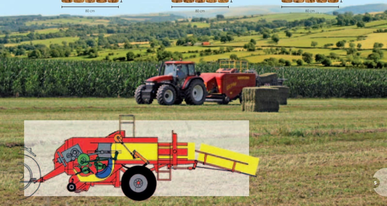
La machine est équipée d'un ameneur rotatif à deux rangées de fourches qui assurent l'introduction de produit. L'ameneur alternatif qui fait 2 cycles d'alimentation chaque coup de piston garantit l'alimentation uniforme de la chambre de pressage. Le système d'alimentation est entraîné par une chaîne, protégé par un boulon de sécurité.
