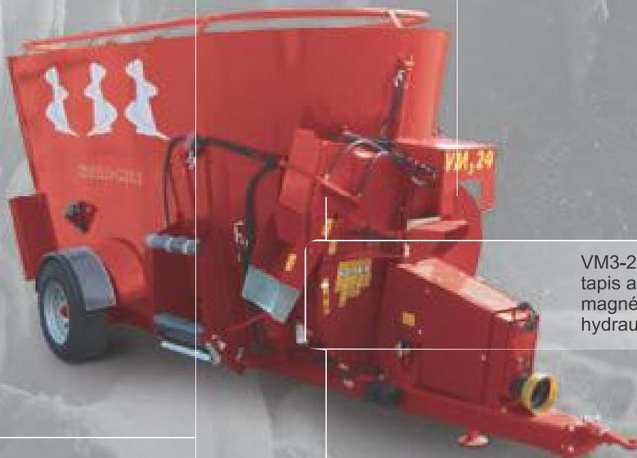
VM3-24m<sup>3</sup> avec déchargement tapis avant droit équipé de plaque magnétique, de contre-couteaux hydraulique et de turbine de paillage.
