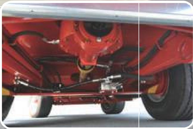
Suspension avec des lames à ressort installée sur l'essieu avant.
