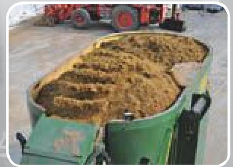
Déchargement d'une SVM2 30 dans un cuve stationnaire de 80 m<sup>3</sup>, située avant le digesteur.
