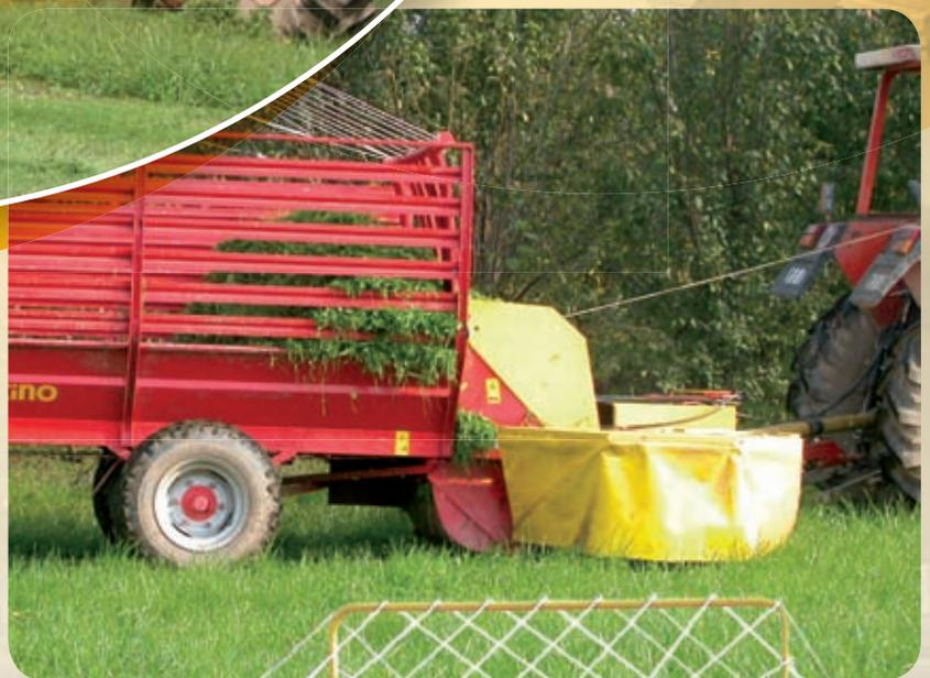
Le modèle CA20 avec attelage sous la prise de force est idéal pour les fermes qui désire une machine stable dans les fortes pentes. Seulement le positionnement de la faucheuse est hydraulique.
