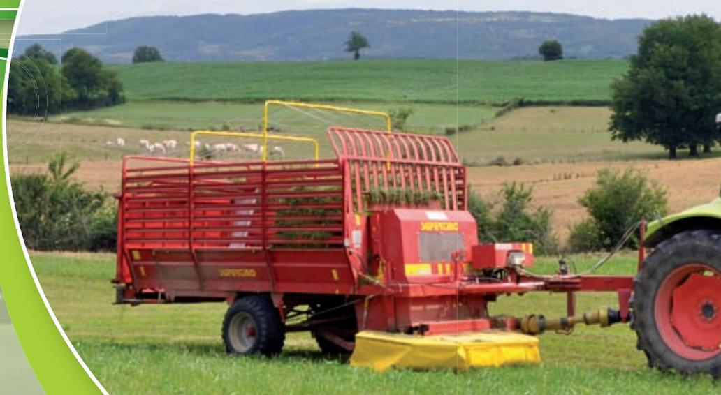
**CA 50**, palier intermédiaire, commandes électriques, pneus 15.0/55-17 et déchargement bilatéral.
