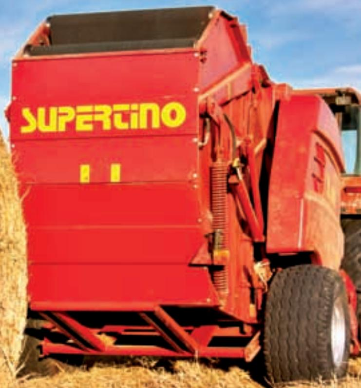
**Un braccio tenditore tappeto provvede a mantenere tramite la pressione idraulica e le molle di tensione la densità voluta all'aumento del volume della balla.**
